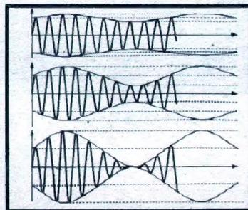
3 Trägerwellen, die verfchieden stark moduliert find. Bei der oberen Welle beträgt der Modulationsgrad 20 %, bei der mittleren 50 und bei der unteren 100 %.
