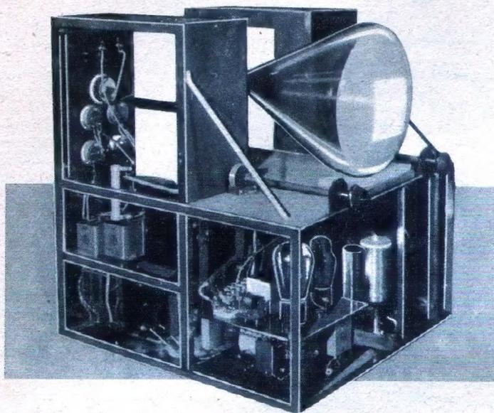
Hier ist ein Fernsehempfänger, wie er heute verwendet wird. Die Apparatur wird beherrscht von der Braun'schen Röhre, auf deren flachem K ölben, dem Leuchtschirm, das ferngesehene Bild erscheint.
