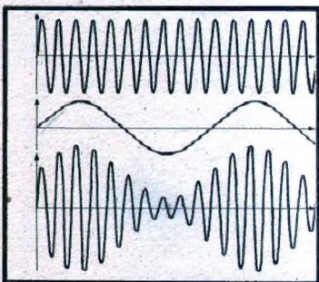
Unfer Bild zeigt 3 verfchiedene Wellenzüge: Die hochfrequente Welle, die fogen. Trägerwelle. Darunter eine tonfrequente Welle. Unten: Die hochfrequente Welle ift mit der ton-frequenten moduliert, das heißt, fie fchwankt in ihrer Stärke in dem Rhythmus der Tonfrequenz.
