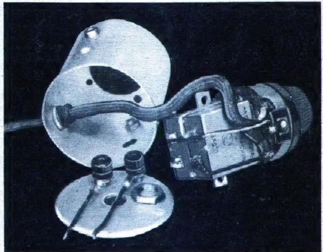
Vor dem endgültigen Zusammenbau. Die Blocks sind bereits aufgelötet und die Schaltung so weit wie möglich fertiggestellt. Links das Abdeckblech mit den beiden nach Einfügen der Blocks einzufetzenden Buchsen und die Befestigungsmutter.
