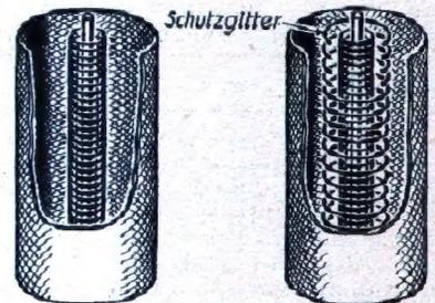
Im Inneren des zylindrischen, hier aufgeschnittenen Fangpolblechs befindet sich der Sprühpol, ein Stäbchen, darum herum als Spirale das Steuergitter. Im rechten Röhrensystem ist das Steuergitter noch vom Schutzgitter umschlossen.
