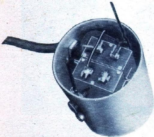
Das Potentiometer mit den Blocks und die Buchsen sind eingesetzt. Nun bedarf es nur noch des Anschlusses der beiden herausstehenden Drahtenden an die eine noch freie Klemme des einen Blocks.
